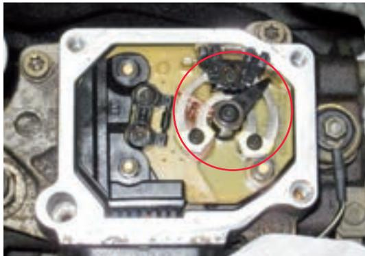
3. Sustituir el sensor de temperatura y volver a montar todo.
