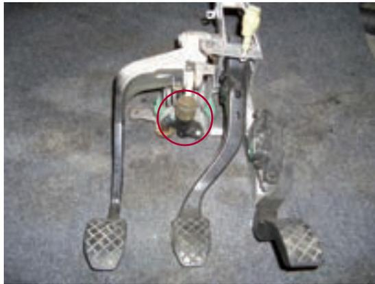
**Conmutador de pedal de freno redundante**
