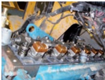
*Conector inyector bomba*
