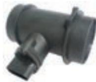
*Sensor de caudal de aire aspirado (caudalímetro)*
